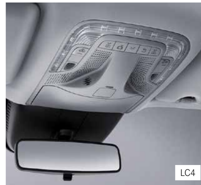
Module de pavillon confort avec de nombreuses fonctions d'éclairage et un range-lunettes
