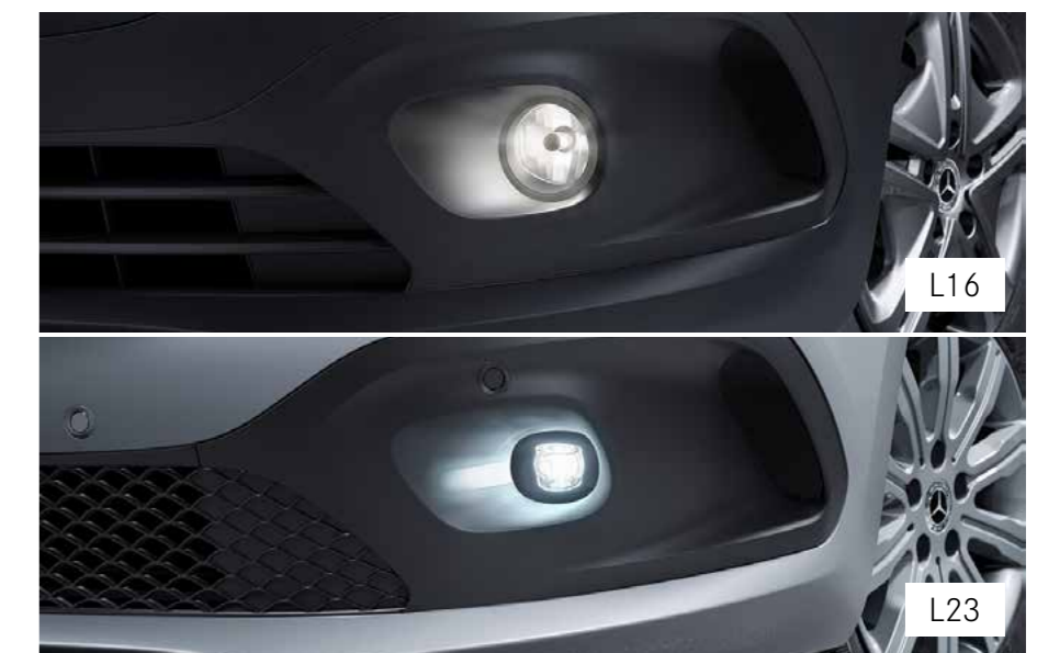
Phares antibrouillard halogènes (L16) Phares antibrouillard à technique LED (L23)(selon la finition)
